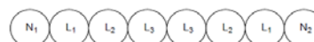
Figuur 52.H.1 — Speciale configuratie voor zes eenaderige kabels (twee eenaderige kabels per fase) en twee eenaderige kabels voor de nul in het platte vlak (zie 523.7)
